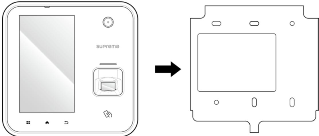
**3** Закрепите BioStation A2 на кронштейне с помощью монтажного винта.
