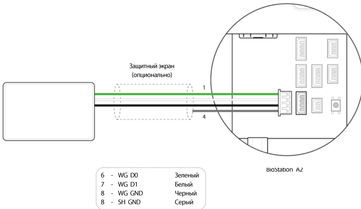
Подключение BioStation A2 к контроллеру СКД
