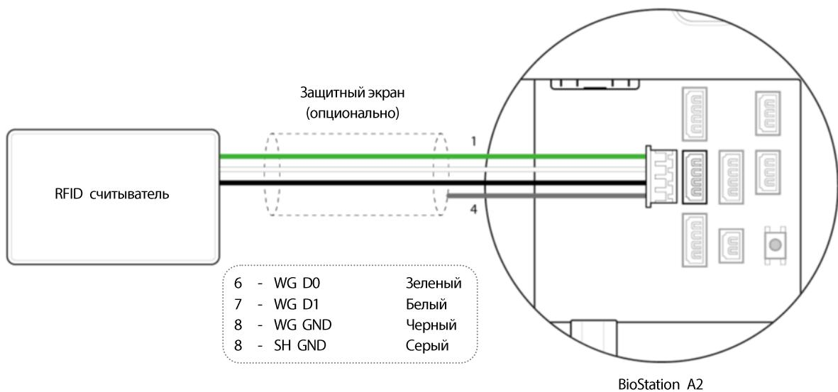
Подключение RFID считывателя к BioStation A2
