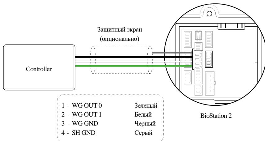
Подключение BioStation 2 к контроллеру СКД
