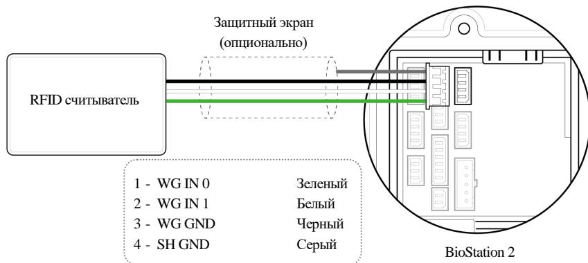
Подключение RFID считывателя к BioStation 2
