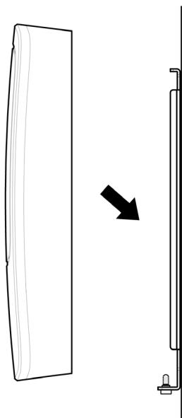
**3** Закрепите XPass 2 на монтажной пластине с помощью крепёжного винта
